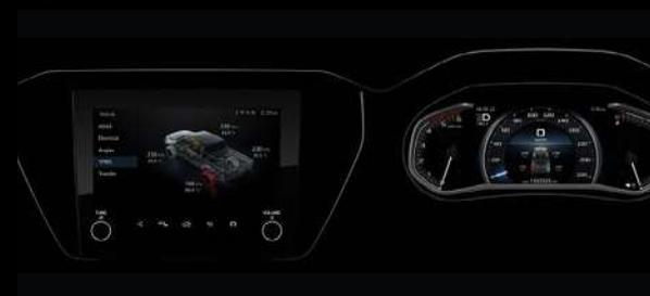
**TPMS (Tyre Pressure Monitoring System).** Este sistema muestra la presión de los neumáticos del vehículo en la pantalla del salpicadero informando al conductor en caso de producirse cualquier anomalía que pudiera afectar a la seguridad de la conducción.
