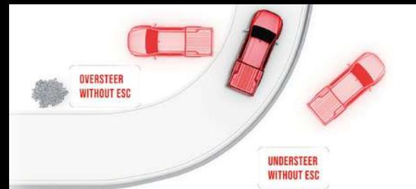
**ESC (Electronic Stability Control).** El sistema ESC controla constantemente la estabilidad del vehículo e interviene automáticamente frenando las ruedas individualmente o reduciendo la potencia del motor para evitar el subviraje o el sobreviraje, lo que ayuda a mantener el control del vehículo en situaciones de emergencia o en carreteras resbaladizas.
