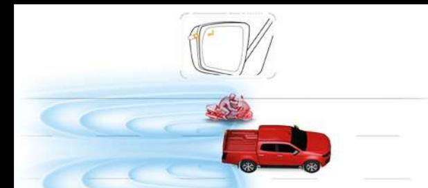
**BSM (Blind Spot Monitoring).** El sistema BSM monitoriza los ángulos muertos y avisa al conductor de la presencia de vehículos que no se ven a través de los retrovisores laterales.
