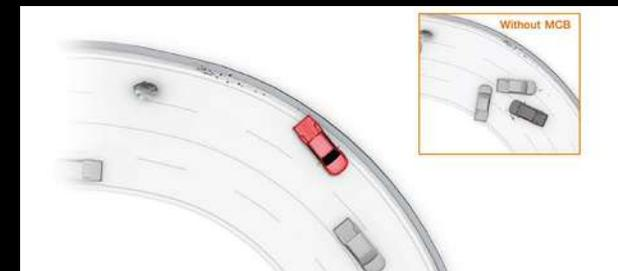
**MCB (Multi-Collision Brake).** El sistema MCB activa automáticamente los frenos tras una colisión inicial, lo que reduce la posibilidad de impactos secundarios y mejora la seguridad general del vehículo.
