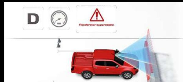
**MAM (Pedal Misapplication Mitigation).** La mitigación de la aceleración involuntaria se refiere a los sistemas diseñados para prevenir o reducir la gravedad de los accidentes causados por una aceleración accidental ante un obstáculo.
